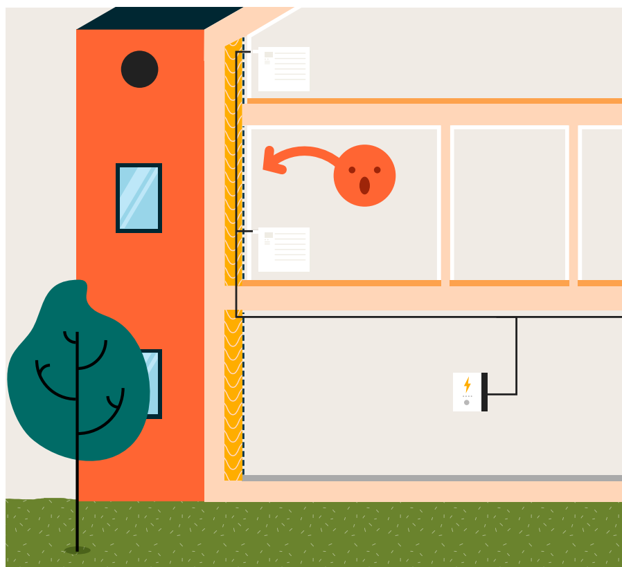
Étape 2 Isolation des murs par l'intérieur
