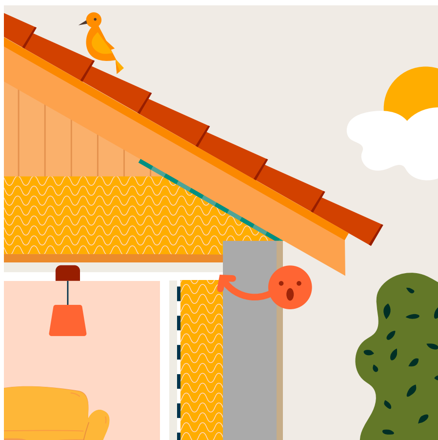
Étape 2 Isolation des combles perdus
