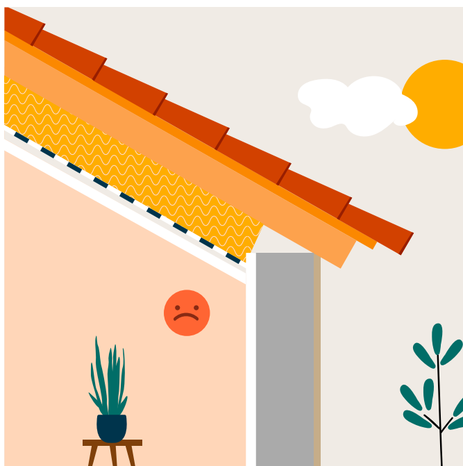
Étape 1 Isolation des rampants
