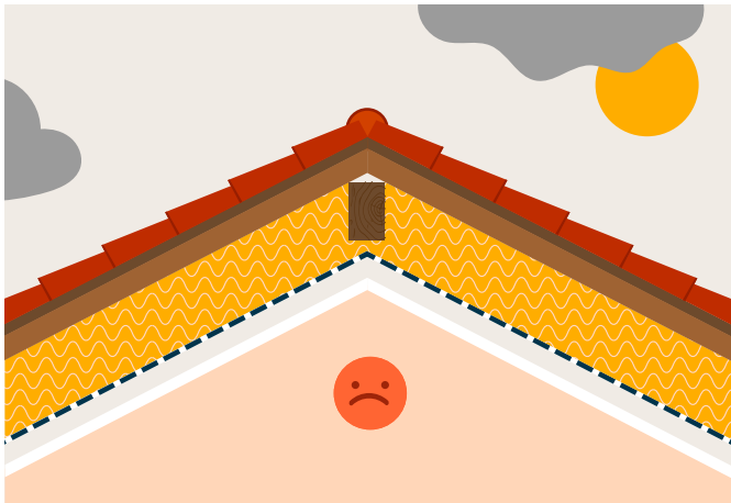
Étape 1 Isolation de la toiture par l'intérieur
