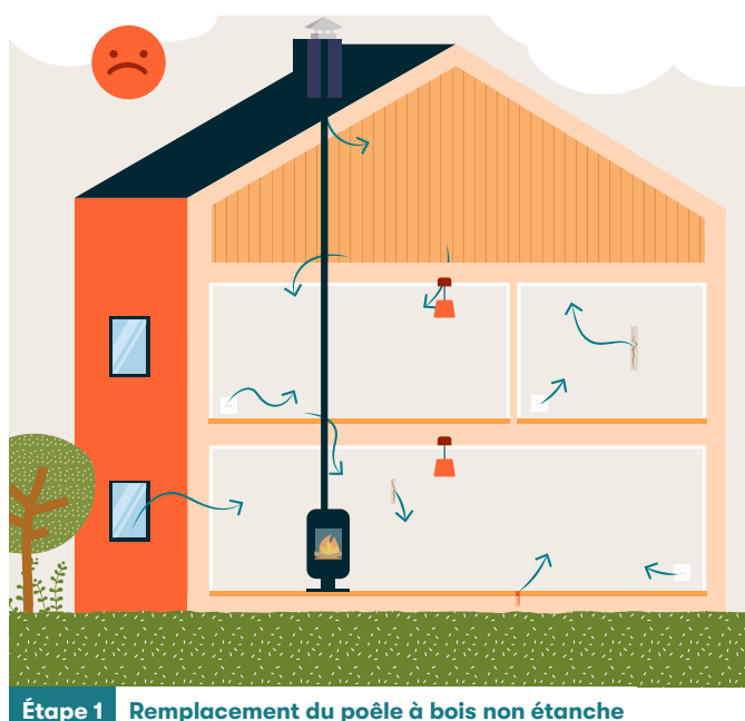
Étape 1 Remplacement du poêle à bois non étanche
