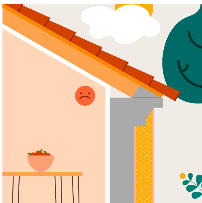
Étape 1 Isolation des murs par l'extérieur
