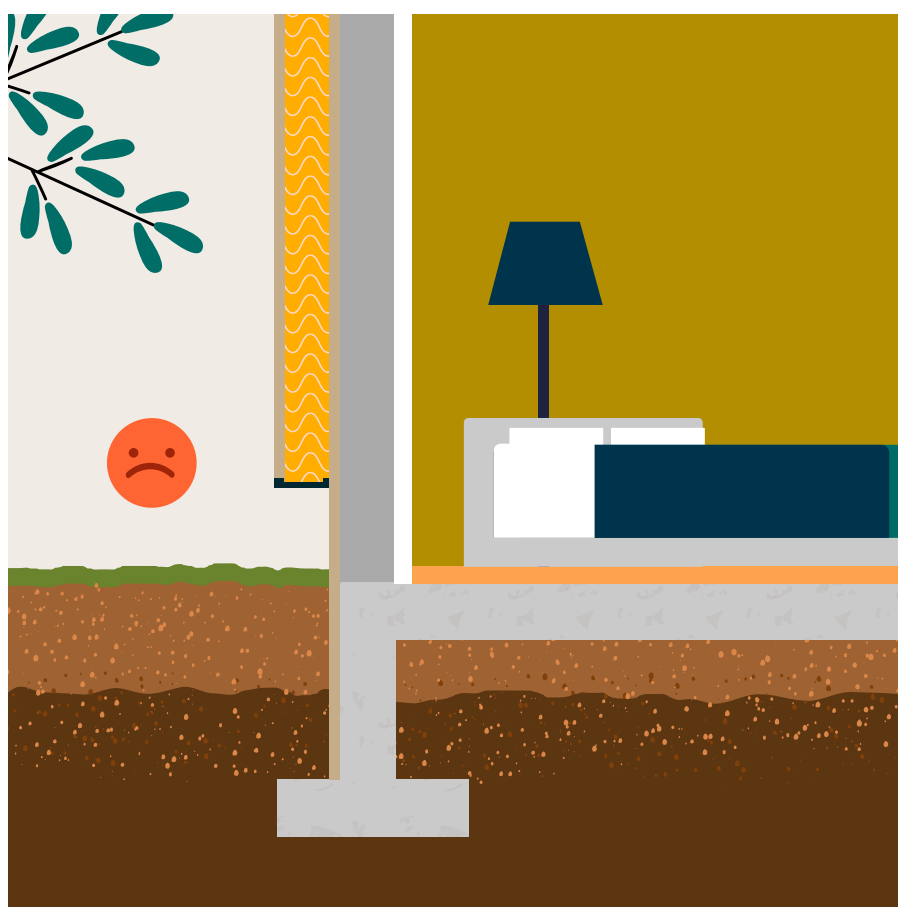
Étape 1 Isolation des murs par l'extérieur
